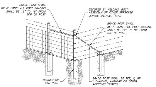
TYPICAL CORNER / END POST BRACING DETAIL
